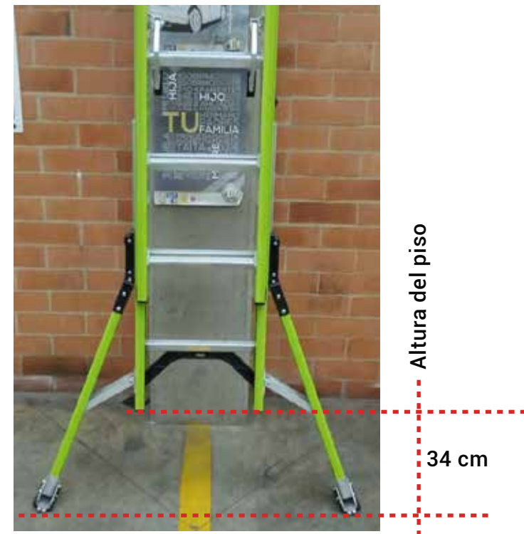
Estabilizadores totalmente abaj
