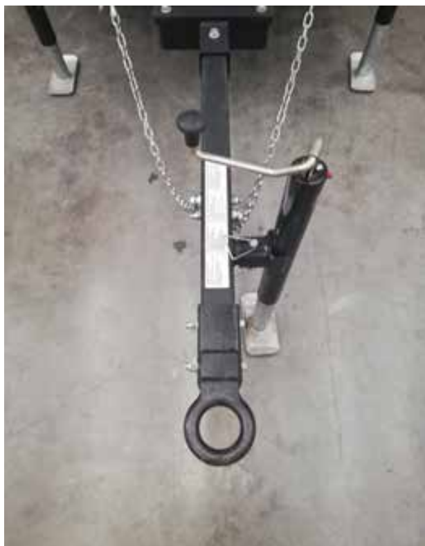
Gancho de remolque desmontable Y 4 bases estabilizadoras para facilitar su nivelación
